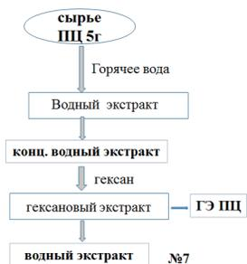
Рисунок 4 – Блок-схема выделение экстракта под условным названием «№7 Вода ПЦ»
